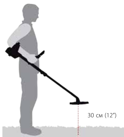
Рисунок 17 – Правильное положение детектора для отстройки от помех
